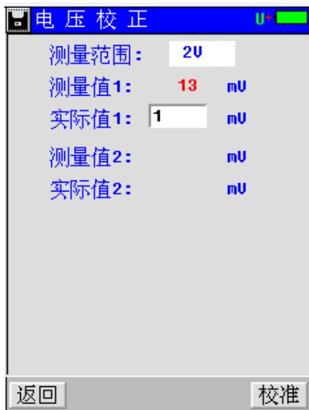
每个通道进行两个测量点的校准，如上图所示。校正前有一个问题必须清楚：每个电压档位都有一个最大的测量值，比如说 12V 档位的最大测量值是 1600mV，当校正此档位时就绝对不能超过这个值。校正方法：一般先从小电压的档位校正，例如校正 12V 档位，选用 1450mV 和 980mV 这两个点来校正；把仪表接到一个可调直流电源上，调节直流电源到 1450mV 左右，用万用表测出这个实际电压，然后输入到实际值 1 中，点击“校准”按钮就完成第一个点校准，并自动跳到下一个点的校准框中，接着再调节直流电源到 980mV 左右，用万用表测出此值，并输入到实际值 2 中，点击“校准”按钮就完成了 12V 档位的电压校准，按同样的方法即可完成其他档位的校准，完成后进入“保存参数”菜单中保存参数，电压校正完成。
