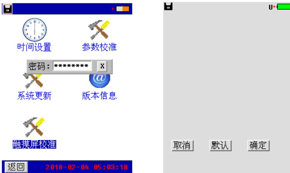
点击触摸屏四周边缘区域,尽量得到触摸屏最接近边界的AD值(屏上会显示触摸点的AD值),单击“确定”按钮会保存校准结果。“默认”按钮则载入仪表默认的触摸屏校准系数,点击“取消”按钮取消本次校准。
