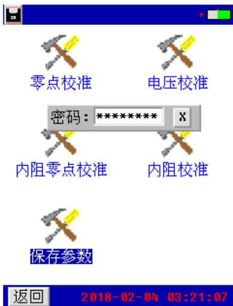
显示输入密码窗口（密码 12345678），输入密码正确后，自动保存参数。
