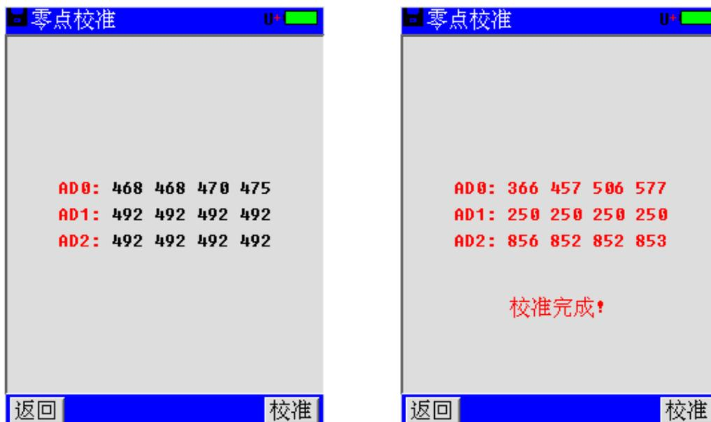
点击“校准”按钮，界面显示“正在校准...”即进入零点校准环节，校准完成后显示“校准完成！”，如图所示，此时已进行一次零点校准。点击“校准”按钮将会进行新的一次校准过程。
