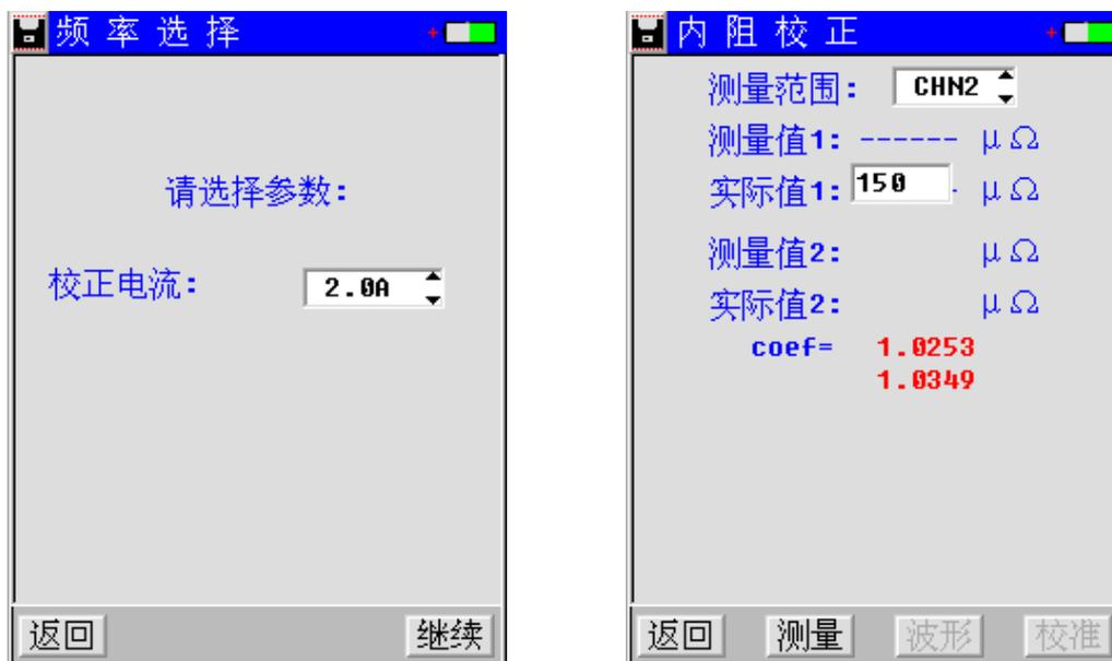
校准方法：内阻校准跟电压校准类似，每个档位校两个我公司提供的标准电阻（也叫分流器）。正确连接好内阻校准线，如校准 0.5mΩ 档，选用 0.25mΩ 和 0.5mΩ 来校准，夹上 0.25mΩ 的标准电阻，点击“测量”，测量完后在实际值 1 中输入“250”，然后点击校准完成第一个电阻的校准；接着再测量 0.5mΩ 的电阻，完成后点击“校准”就可完成 0.5mΩ 档的校正。按同样的方法即可完成其他档位的校准。校准 1.0mΩ 档，选用 0.5mΩ 和 1.0mΩ 来校准，校准 3.7mΩ 档，选用 1.0mΩ 和 3.75mΩ 来校准，校准 15mΩ 档，选用 3.75mΩ 和 15mΩ 来校准。校准完所有档位后，进入到“保存参数”菜单中保存参数，内阻校正完成。
