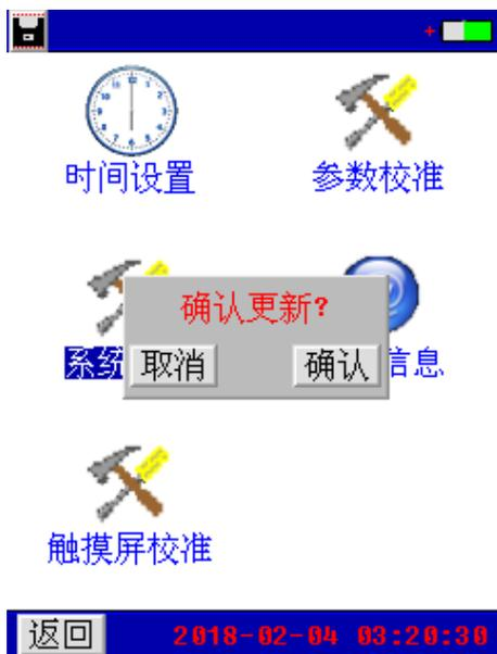
点击“确认”按钮，即进入软件更新程序。此时仪表自动重启，并载入U盘的更新文件至仪表，软件更新完成后，仪表进入开机界面，可进行正常的操作。
