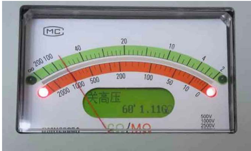
关闭高压输出完成吸收比测试，显示测试结果如下图
