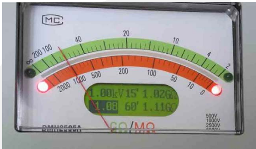
关闭高压输出完成吸收比测试，显示测试结果如下图
