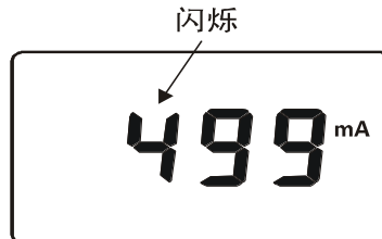
图14. 电流报警临界值设定
